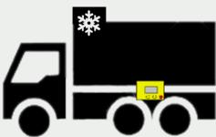
Platzieren Sie den Detektor auf der Fahrgestellstruktur des Fahrzeugs (siehe Abbildung), nicht auf der Karosserie. Es ist wünschenswert, dass die Kühlung während der Detektion ausgeschaltet ist. Wenn die Kühlung des Fahrzeugs nicht ausgeschaltet werden kann, kann die Erkennung durchgeführt werden, aber die Zuverlässigkeit der Erkennung kann beeinträchtigt werden.
