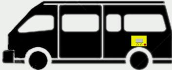
Platzieren Sie den Detektor an der Karosserie über dem Hinterrad, siehe Abbildung, idealerweise an der Seite des Fahrzeugs, an der sich keine Schiebetür befindet.
