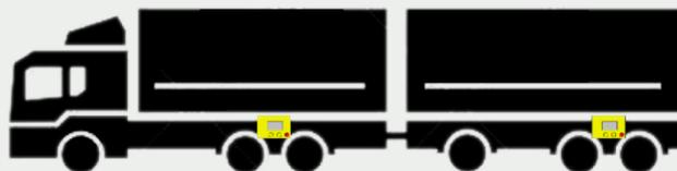
Platzieren Sie den Detektor auf der Fahrgestellstruktur des Fahrzeugs und des Anhängers, siehe Bild, nicht auf deren Karosserie oder dem darauf befindlichen Container.
