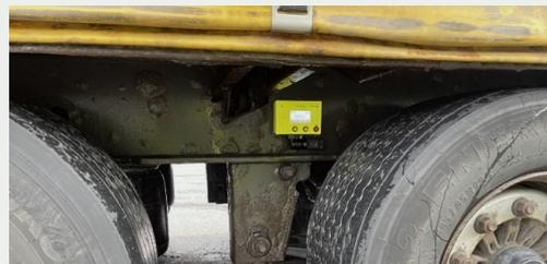
Bringen Sie den Detektor an der Fahrgestellstruktur der Zugmaschine und des Anhängers an (siehe Bild), nicht am Aufbau der Zugmaschine oder des Containers. Wenn der Tankwagen eine flüssige Ladung transportiert, muss das Fahrzeug vor der Erkennung mindestens 5 Minuten lang stehen bleiben.
