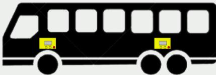
Platzieren Sie den Detektor auf der Fahrgestellstruktur des Fahrzeugs, siehe Bild, nicht auf der Karosserie oder der Außenhaut des Fahrzeugs. Wenn die Fahrzeugstruktur eine solche Erkennung nicht zulässt (z. B. wegen fehlendem Zugang zum Fahrgestell), öffnen Sie die Staufächer des Busses und platzieren Sie den
