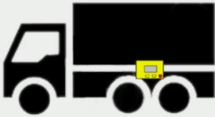
Platzieren Sie den Detektor auf die Fahrgestellstruktur des Fahrzeugs, siehe Bild, nicht auf die Karosserie des Fahrzeugs oder den Container auf dem Fahrzeug.
